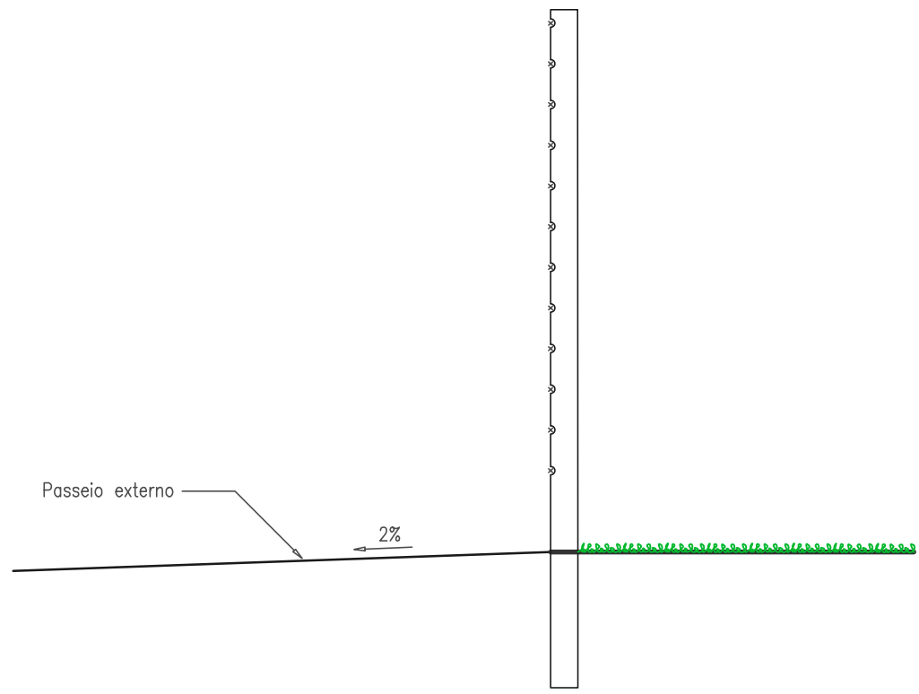
CORTE TRANSVERSAL ESQUEMÁTICO DA CERCA 12 FIOS PERIMETRAL – ESC.: 1:25
